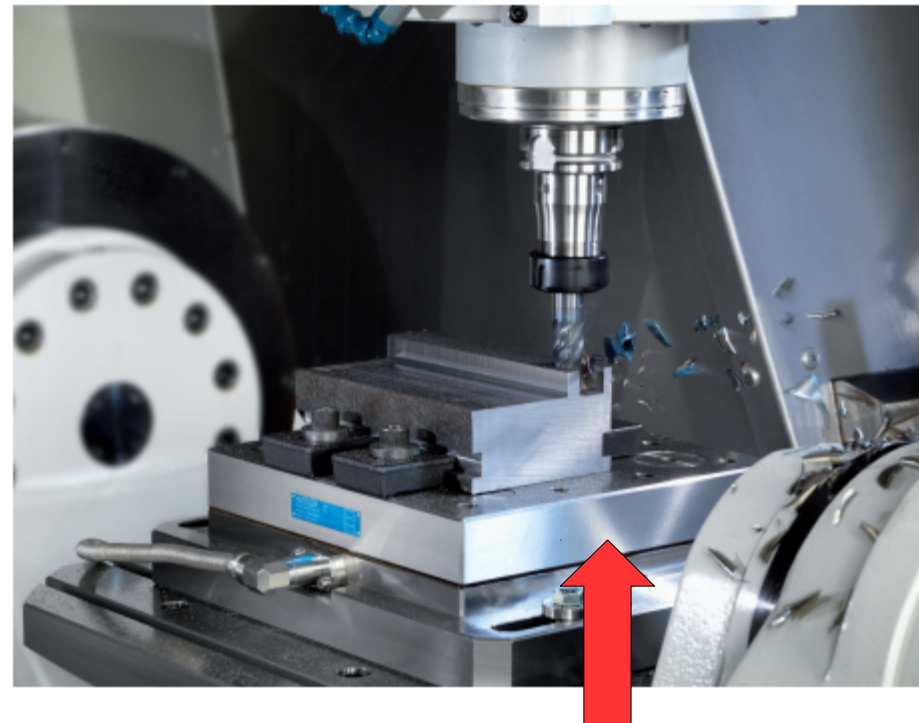
Fresatura di particolare in acciaio ad elevata durezza controllata attraverso dinamometro stazionario
